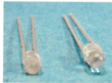
Eine warm weiße 3-mm-LED wird am Kopf abgeflacht und sehr fein ein Stück eingebohrt
